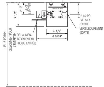
REMARQUE : NE PAS MONTER LE FILTRE DERRIÈRE LA MACHINE À GLAÇONS OU D'AUTRES APPAREILS POUVANT BLOQUER L'ACCÈS POUR L'ENTRETIEN DU SYSTÈME DE FILTRATION.
