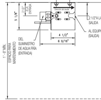
NOTA: NO MONTEAR EL CONJUNTO DEL FILTRO DETRÁS DE UNA MÁQUINA DE HIELO U OTROS ARTEFACTOS QUE DIFICULTEN EL ACCESO PARA EL MANTENIMIENTO DEL SISTEMA DE FILTRACIÓN.
